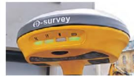
oberen Ende sich der Empfänger für Navigationssatellitendaten, ein e-survey E100, befindet. Die Gerätekombination empfängt von mindestens drei Satelliten Daten zur genauen Lagebestimmung. „Im Prinzip funktioniert das wie ein Navigationsgerät im Auto, nur viel genauer“, sagt Rocco Haberland, „insbesondere, weil die SAPOS-Daten des Landesvermessungsamtes zur Korrektur herangezogen werden.“ Auf
